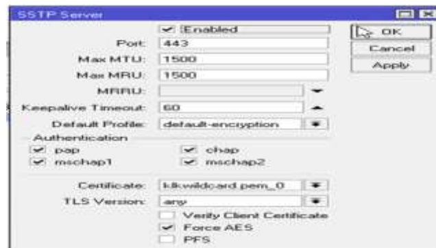
Gambar 8. Setup SSTP Server di Mikrotik
